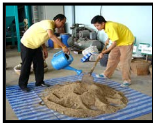
3) เทลงในวัตุดิบคลุกเคล้าให้ทั่วกัน และปรับความชื้นโดยใช้น้ำ
